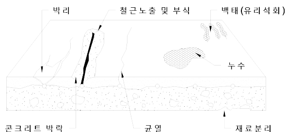
(a) 콘크리트 바닥판
